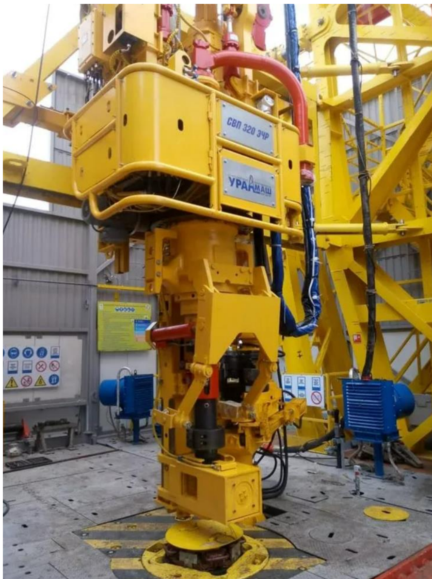
2.2 Сурет – Оралмашзаводтан 320 ЭЧР жоғарғы жетек жүйесі
